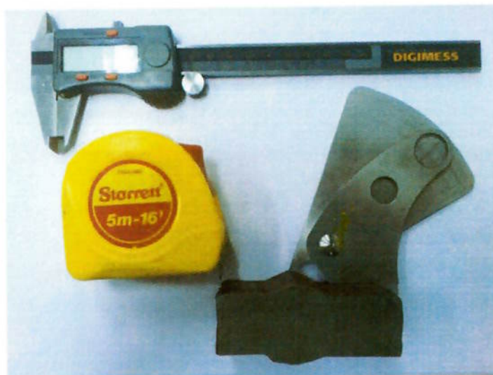
Figura 49 - Instrumentos utilizados para medir as dimensões dos cordões de solda.
