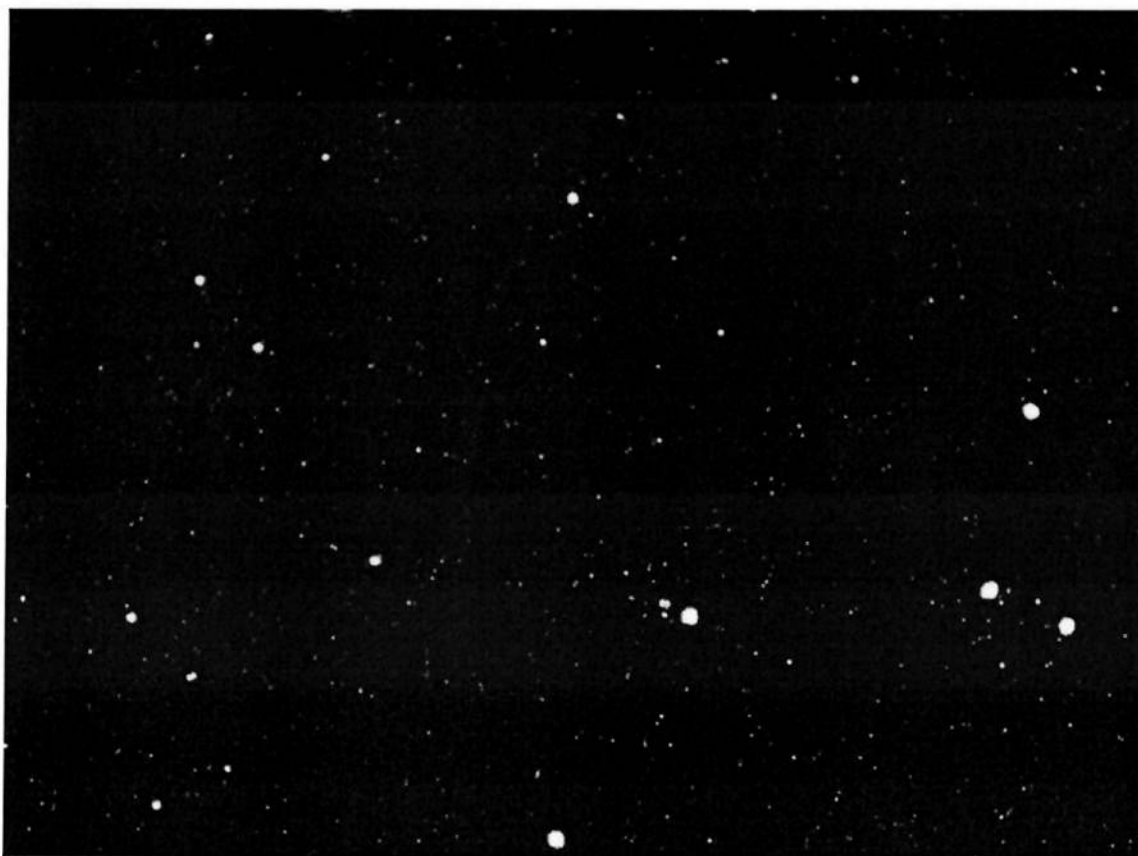
Figura 57 - Exemplo de Micrografia em Campo Escuro para detecção de inclusões (Aumento de 200X).
