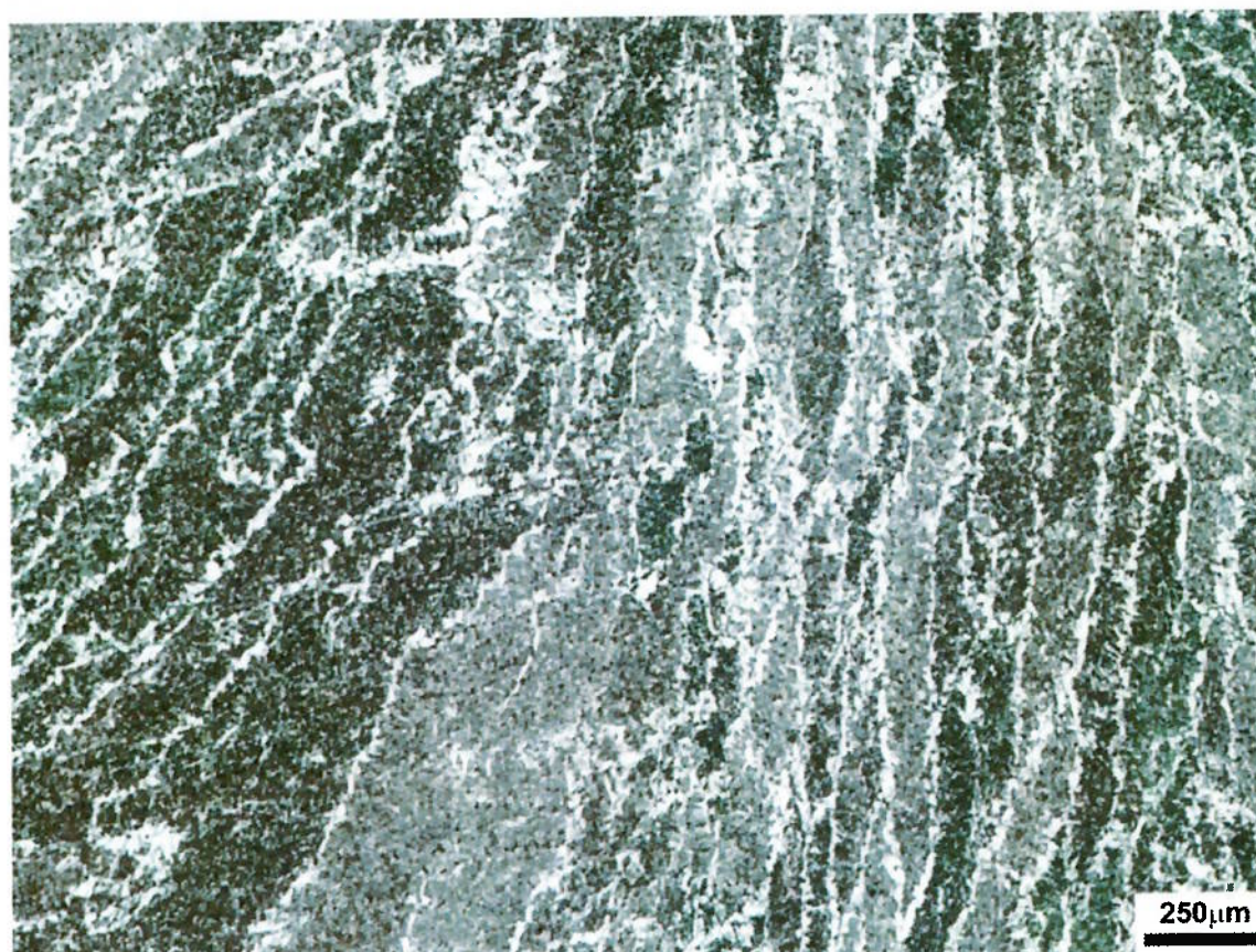
Figura 86 - Micrografia da Região 1 - Centro do segundo passe de solda do CP - DX. Aumento de 50X. Ataque Nital 2%.
