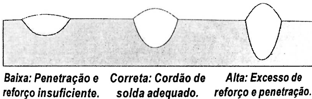
Figura 17- Influência da corrente de soldagem no perfil do cordão. [11]
