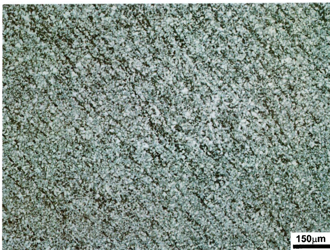
Figura 82 - Micrografia da Região 2 – Região de refino do CP - NAV. Aumento de 100X. Ataque Nital 2%.
